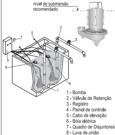
INSTALAÇÃO TÍPICA BOMBAS WDM MULTIESTÁGIOS
