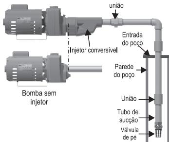
INSTALAÇÃO TÍPICA BOMBAS WDM DE ÁGUA RESIDUAL
