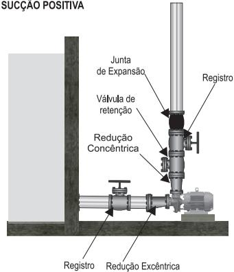
INSTALAÇÃO TÍPICA BOMBAS WDM JET
