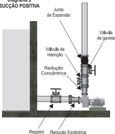
INSTALAÇÃO TÍPICA BOMBAS WDM JET
