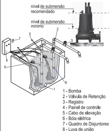
INSTALAÇÃO TÍPICA BOMBAS WDM MULTIESTÁGIOS
