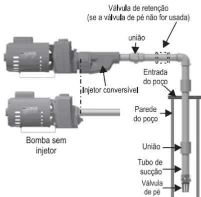
INSTALAÇÃO TÍPICA BOMBAS WDM DE ÁGUA RESIDUAL
