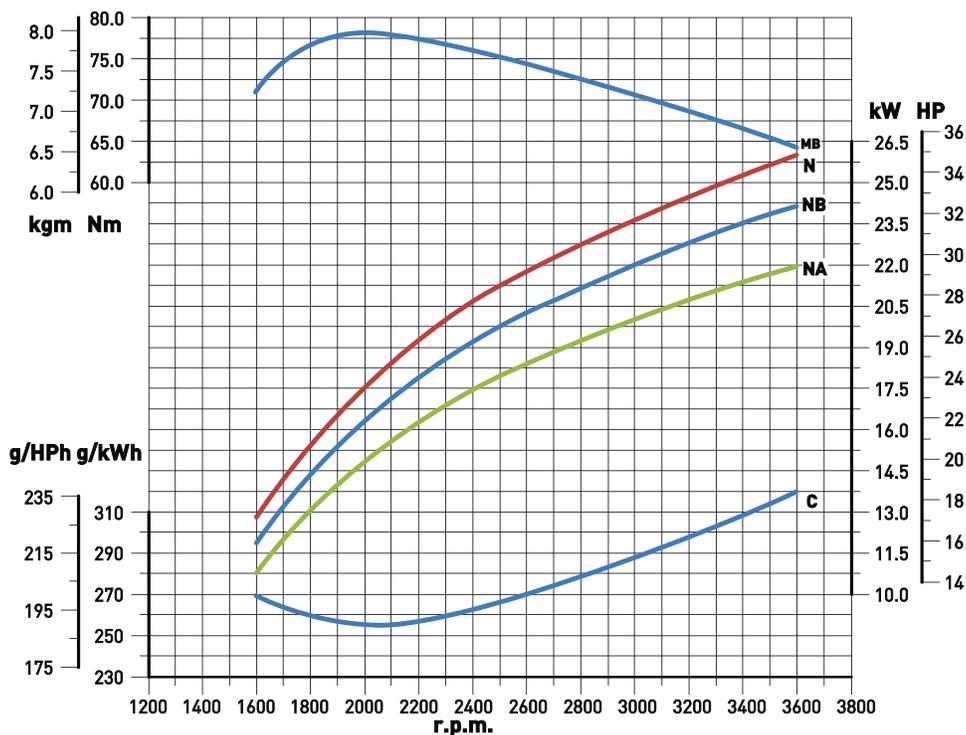
**N** - Curva de potencia - 80/1269/CE E-ISO 1585      **MB** - Curva de par (en curva NB)
